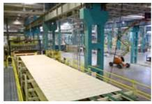
jusqu'à 20.50 m de long en épaisseurs de 19 à 106 mm, grâce à un outil industriel innovant permettant d'accélérer le séchage. Différentes qualités sont fabriquées, tant en résistance qu'en finition.
